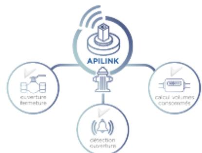
Ces dispositifs de surveillance connectés détectent l'ouverture et la fermeture des poteaux, et calculent les volumes consommés.
